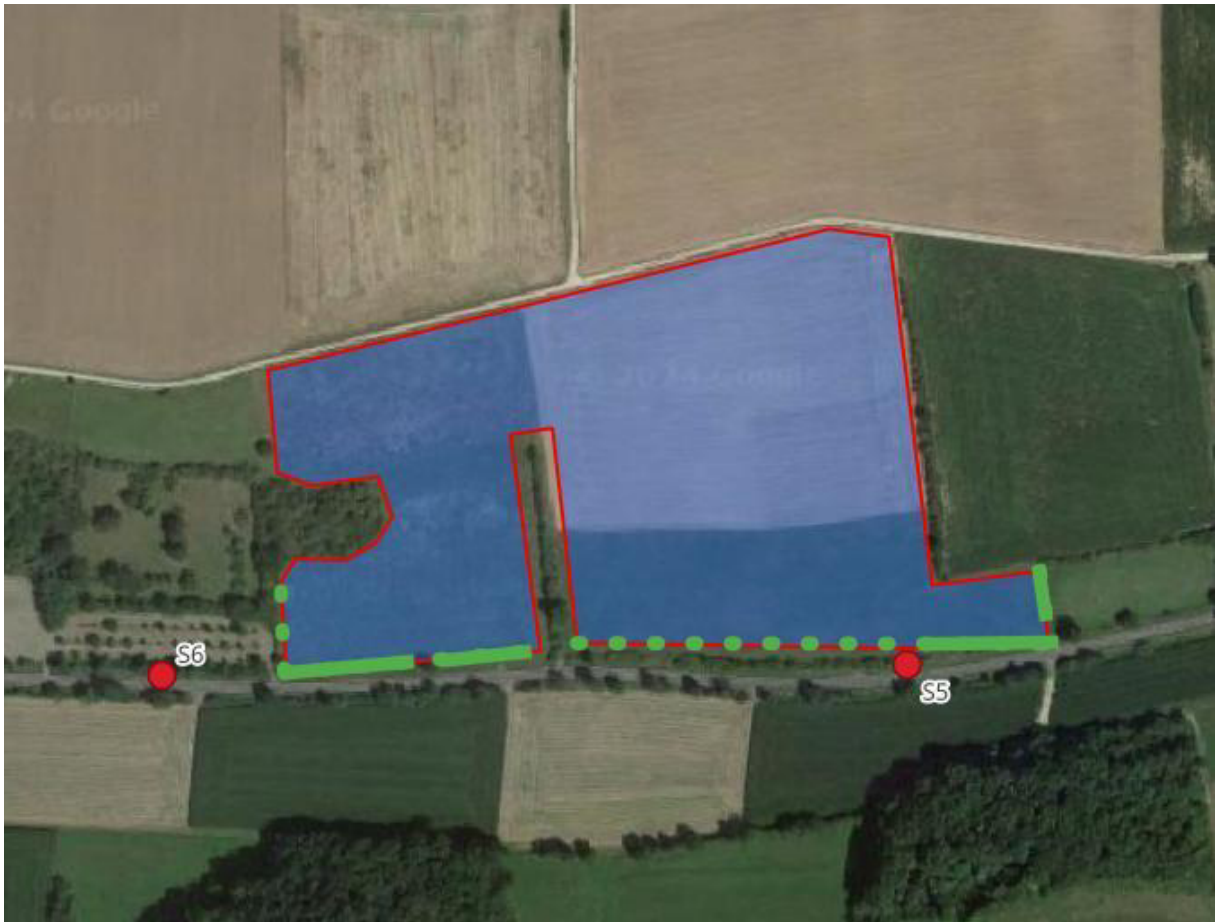
Abbildung 14: Blendschutzmaßnahmen, durchgezogene Linie: werden benötigt um Lücken in den Bestandsgehölzen zu schließen, gepunktet: werden nur benötigt wenn der Gehölzbestand nicht erhalten werden kann, Hintergrund: Google Earth Pro
