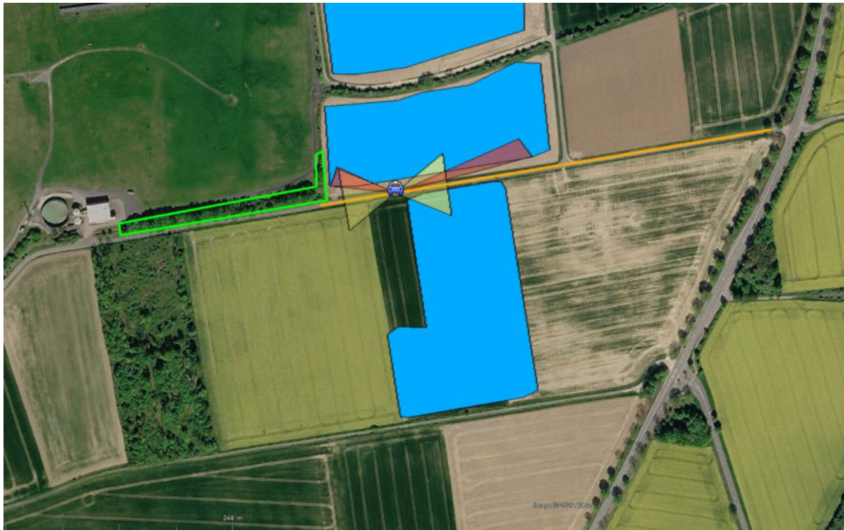
Abbildung 14: Streckenabschnitt mit Reflexionen im relevanten Sichtfeld der Verkehrsteilnehmer auf der Straße Mülldeponie in Orange, relevantes Sichtfeld in Gelb, Immissionswinkel möglicher Reflexionen von der Modulfläche in Rot, bestehende Sichtunterbrechung durch Vegetation in Grün (Quelle: Google Earth, Airbus)
